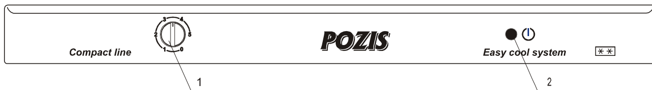
Рис.2. Регулировка температурного режима
